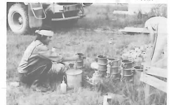
写真3 空気取入れチャンバー建築工事ビットのベースマットコンクリートの空気量の測定
