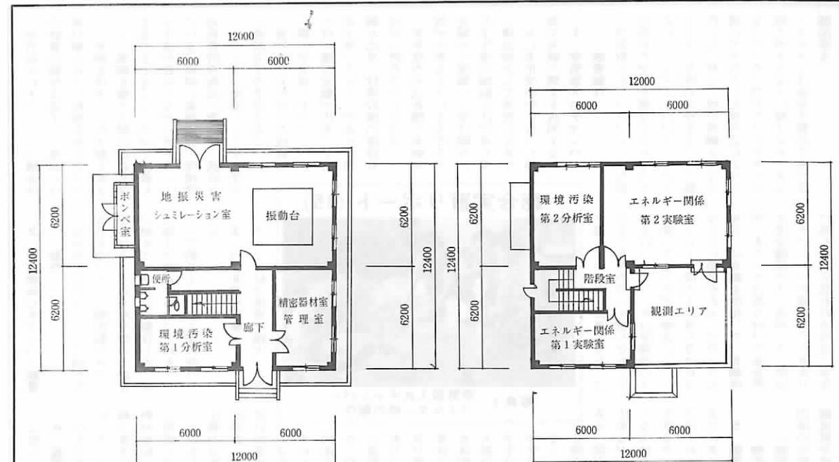
図-1 環境開発教育研究施設平面図 (延床面積  $262.8\text{m}^2$ )
