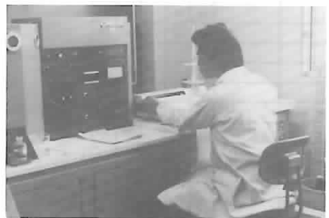
写真3. 環境汚染第2分析室 高周波アルゴンプラズマ分析装置
