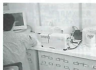
融点や重量減少や物質の熱的性質を測定します。DTAはDTAと似ていますが、定量性がよく、物質の反応熱の精密測定等に使われます。
