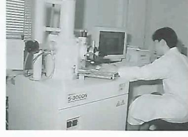
電子線を用いて物体表面を観察する顕微鏡です。可視光線による光学顕微鏡では見ることのできない最高10万倍までという高倍率で観察を行うことができ、また表面の凹凸の様子や細菌等の水分を含む物質の観察も可能となっています。
