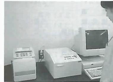
光学的異方性をもつ物質が、偏光性が解消される現象を測定する装置です。物質間の相互作用が観察できる装置で、例えばホルモンと受容体の結合などが測定できます。
