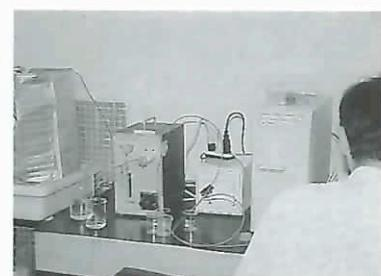
反応容器の中に試薬を導入して化学反応を行わせ、検出器で得られる信号を解析して反応系の解析、定量を行う装置です。本装置は化学反応の定量システムに新境地を開くものです。
