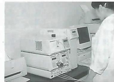
最高三液まで溶媒の混合ができ、紫外・可視および蛍光検出器を備えています。セミ分取から分析目的までの幅広い用途に利用可能です。化合物の精製から微量の生体成分の分析まで使用できます。
