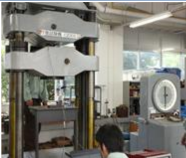
万能試験機での実験
