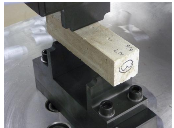
図 2 PCM の曲げ強度試験
