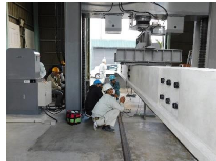
写真 3 曲げ載荷試験およびひび割れ観測 (BS12)
