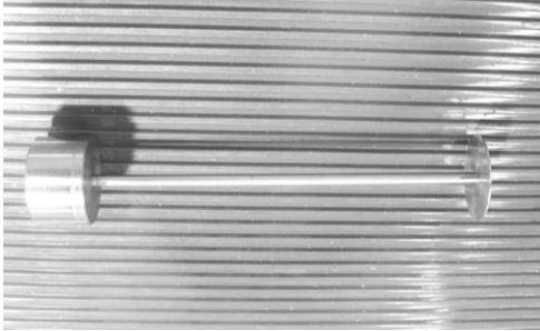
図 5 製作したソレノイドの芯
