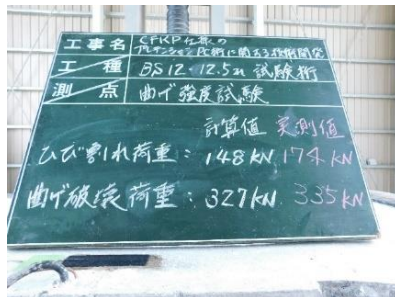
写真 6 ひび割れ荷重および曲げ破壊荷重
