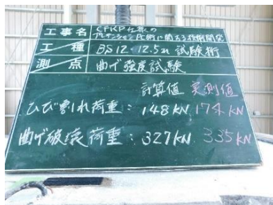
写真 6 ひび割れ荷重および曲げ破壊荷重
