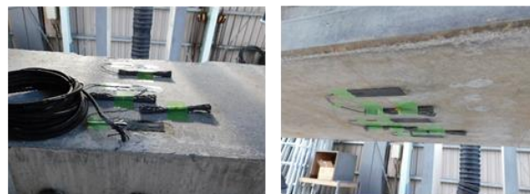
写真 4 曲げ試験体上下面のひずみゲージ貼付状況
