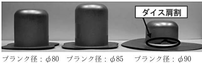
Fig. 4.2 チタン(TP270C) Type5  $r_p=8, r_d=r_s=4$ の成形例
