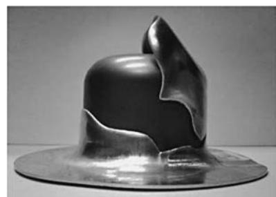
Fig. 4.17 二層深絞りの特徴的な破断例 (Al.O/Ti.I)
