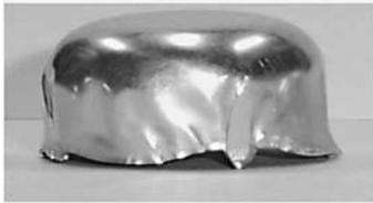
Fig. 4. 5 アルミニウム単層成形例
