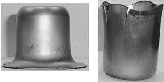
Fig. 4.10 ステンレス単層の成形例と置き割れ例
