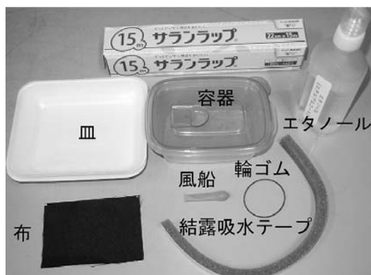
図2 簡易霧箱の材料
