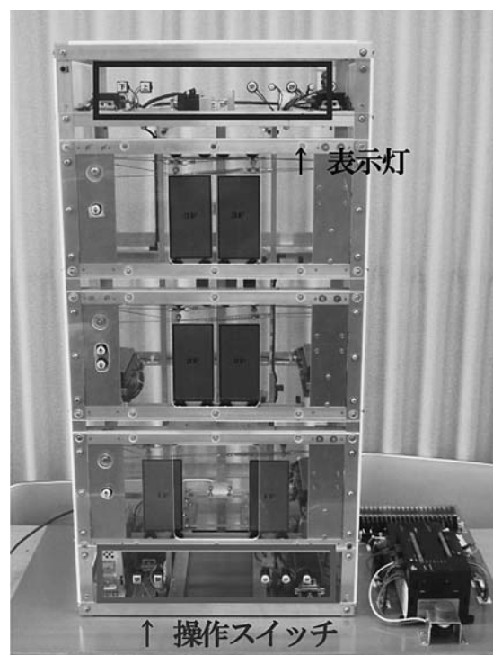
図 8 擬似エレベータ実験装置（全体）
