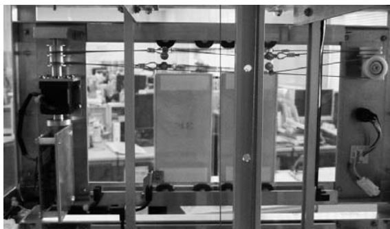
図. 9 各階の扉の開閉機構
