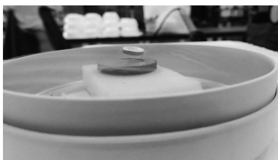
図 7 作製した超伝導体の上に浮くネオジム磁石
