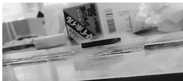
図 8 ネオジム磁石の上に浮く超伝導体
