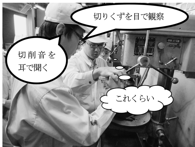
図2 手仕上げパート（穴あけの様子）
