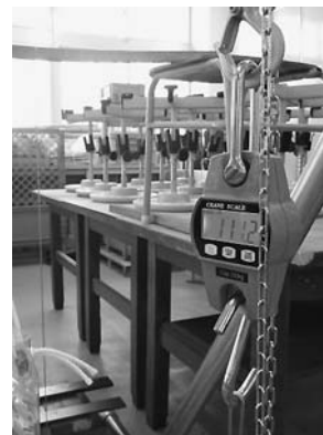
写真12. クレーンスケールの値 (重り設置後)
