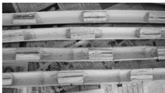
写真3 半割丸太と竹の接合
