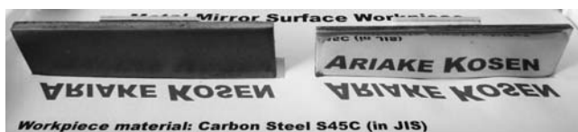
(a) 加工前 (b) 加工後 図 9 金属鏡面サンプルの加工前と加工後の比較
