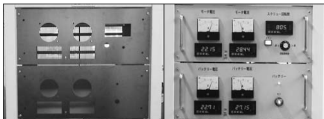
塗装前 機器取付け後 図6 前面パネル部の塗装前と完成後
