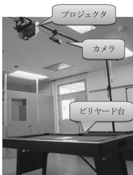
図1 使用機材の配置
