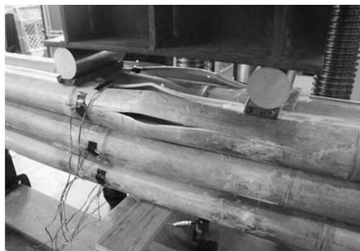
写真6 試験体最大耐力時の中央部分の破壊状況
