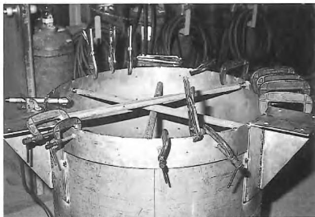
写真8 外周補強板クランプ中の本体容器
