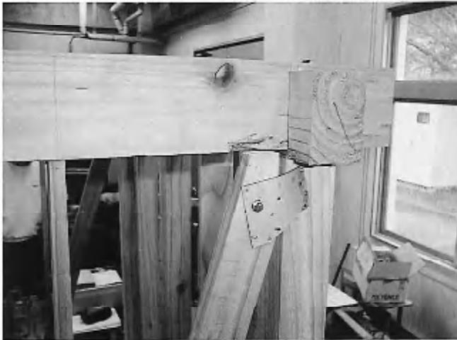
写真-2 筋かい端部の引き抜き (試験体2)
