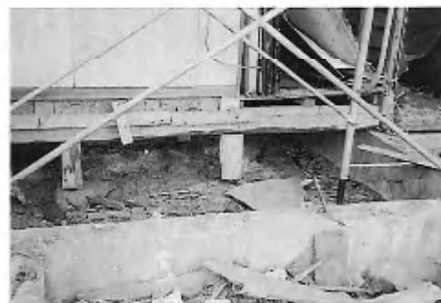
写真-7 水平加力時の加力妻面（7通り）床束の浮き上がり
