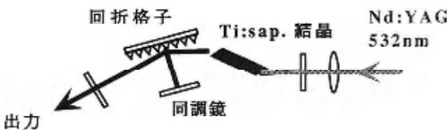
図2 チタンサファイアレーザの発振部。同調鏡をステッピングモータにより回転する。
