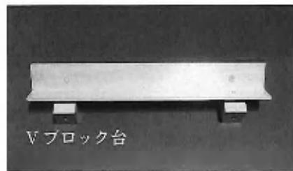
写真9 アルミニウム製のチューブガイド部
