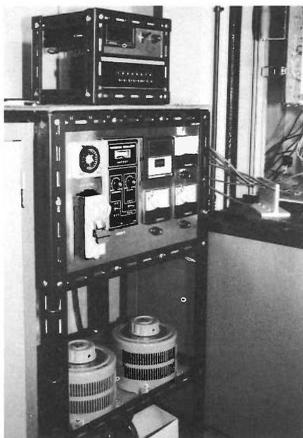
写真3 電気炉電源部
