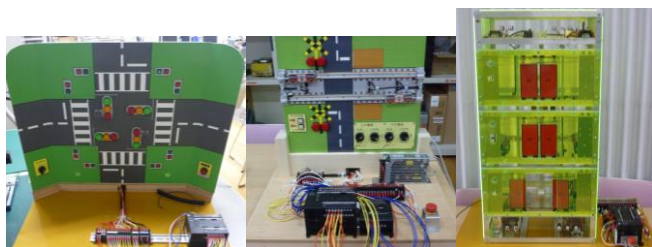
図2.2 疑似実験装置 (疑似交差点、疑似踏切、疑似エレベータ)
