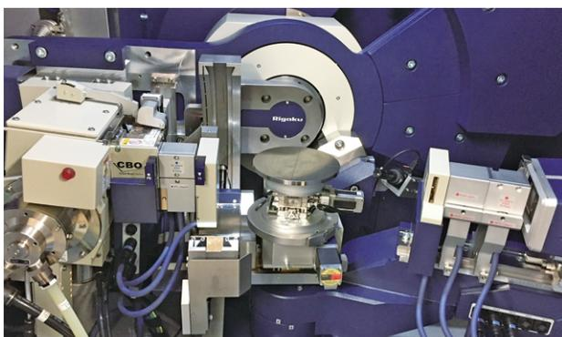
圧電薄膜評価に用いたX線回折装置
