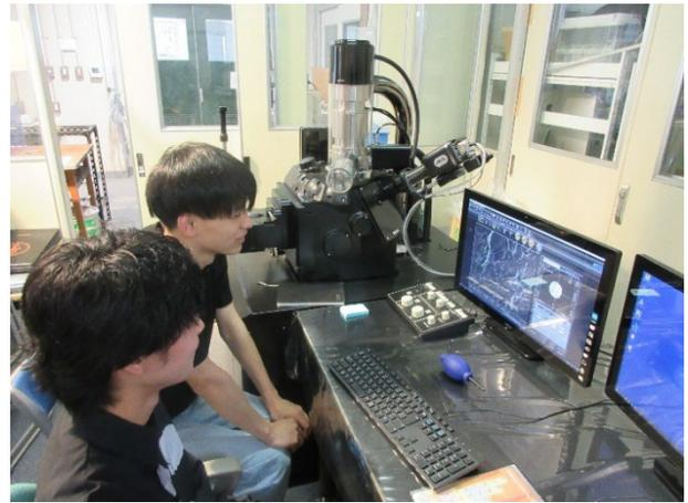
図10 SEMによる破断面の観察の様子
