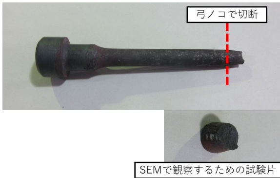
図8 引張試験後の試験片とSEM観察用試験片
